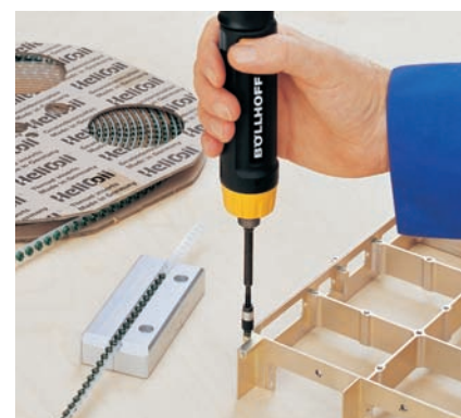
Montaż HELICOIL® plus
