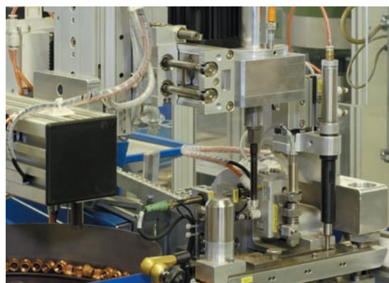
Automatyczny montaż wkładek HELICOIL®plus M 8 SCREWLOCK®.
